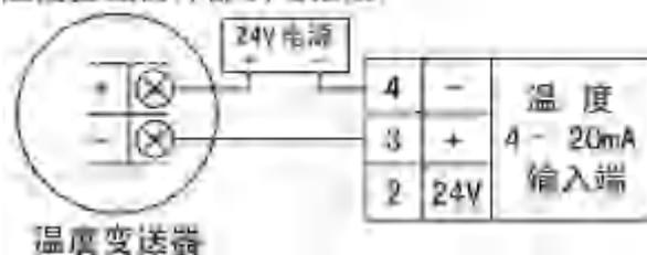
压力变送器本机供电接线:
