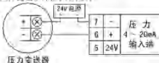
差压变送器或流量计本机供电接线:
