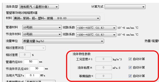
D. 当流量积算仪用来测量水流量时，【流体类型】选择“水”。【流体类型】为“水”时，【流体物性参数】输入区中的内容下图红框所标示。
