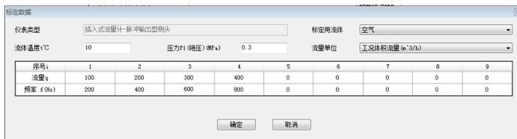
“脉冲输出型测头——标定数据”输入界面
