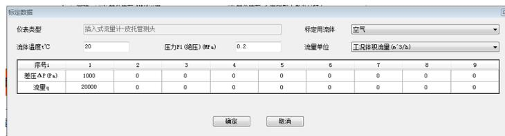
“皮托管测头——标定数据”输入界面
