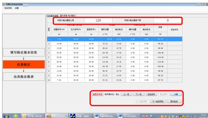
【积算仪输出量程上限】输入框必须输入。该输入值为被检流量积算仪中设置的输出 20mA 电流所对应的流量值（一般为“瞬时流量量程值”），单位同【检定基本信息界面-被检表工作状态-流量单位】，软件默认值为“200”。
