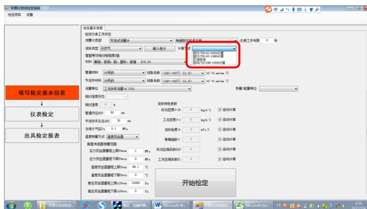
A-2.当【节流件型式】为“角接取压标准孔板”、“法兰取压标准孔板”、“D 和 1/2D 取压标准孔板”、“ISA1932 喷嘴”、“长颈喷嘴”、“具有粗铸收缩段的经典文丘里管”、“具有有机加工收缩段的经典文丘里管”、“具有焊接铁板收缩的经典文丘里管”、“文丘里喷嘴”中的一个选项，并且【流体类型】选择“单一气体”、“混合气体”、“饱和蒸汽（温度补偿）”、“饱和蒸汽（压力补偿）”、“过热蒸汽”、“水”、“其它液体”、“其它气体”时，在【节流
