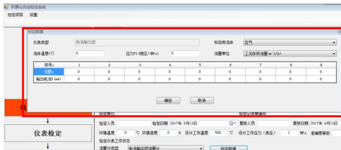
请按照实际检定的条件，对【标定用流体】、【流量单位】进行选择；并将标定时所用流体的温度、压力，以及标定试验点流量与对应的输出电流的数值填入表中。单击 **确定** 按钮后，软件将保存这些数据，并回到上一级画面，单击 **取消** 按钮，软件将不保存返回。
