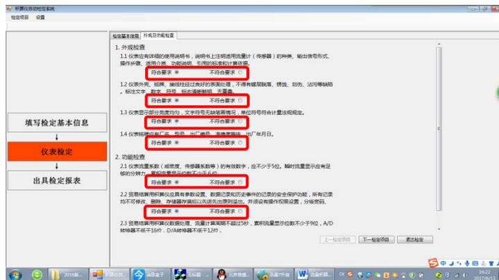
在“仪表检定—外观及功能检查”界面中，列出了 JJG1003-2016 对流量积算仪的外观及功能要求，每项要求下面都有 **符合要求**、**不符合要求** 单选按钮，见上图中红框所标示位置，根据被检定的流量积算仪实际情况逐项判定是否满足要求。
