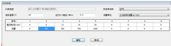
“电流输出型测头——标定数据”输入界面
