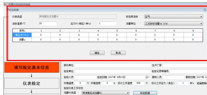
请按照实际标定的条件，对【标定用流体】、【流量单位】进行选择；并将标定时所用流体的温度、压力，以及标定试验点流量与对应差压的数值填入表中。单击 确定 按钮后，软件将保存这些数据，并回到上一级画面，单击 取消 按钮，软件将不保存返回。
